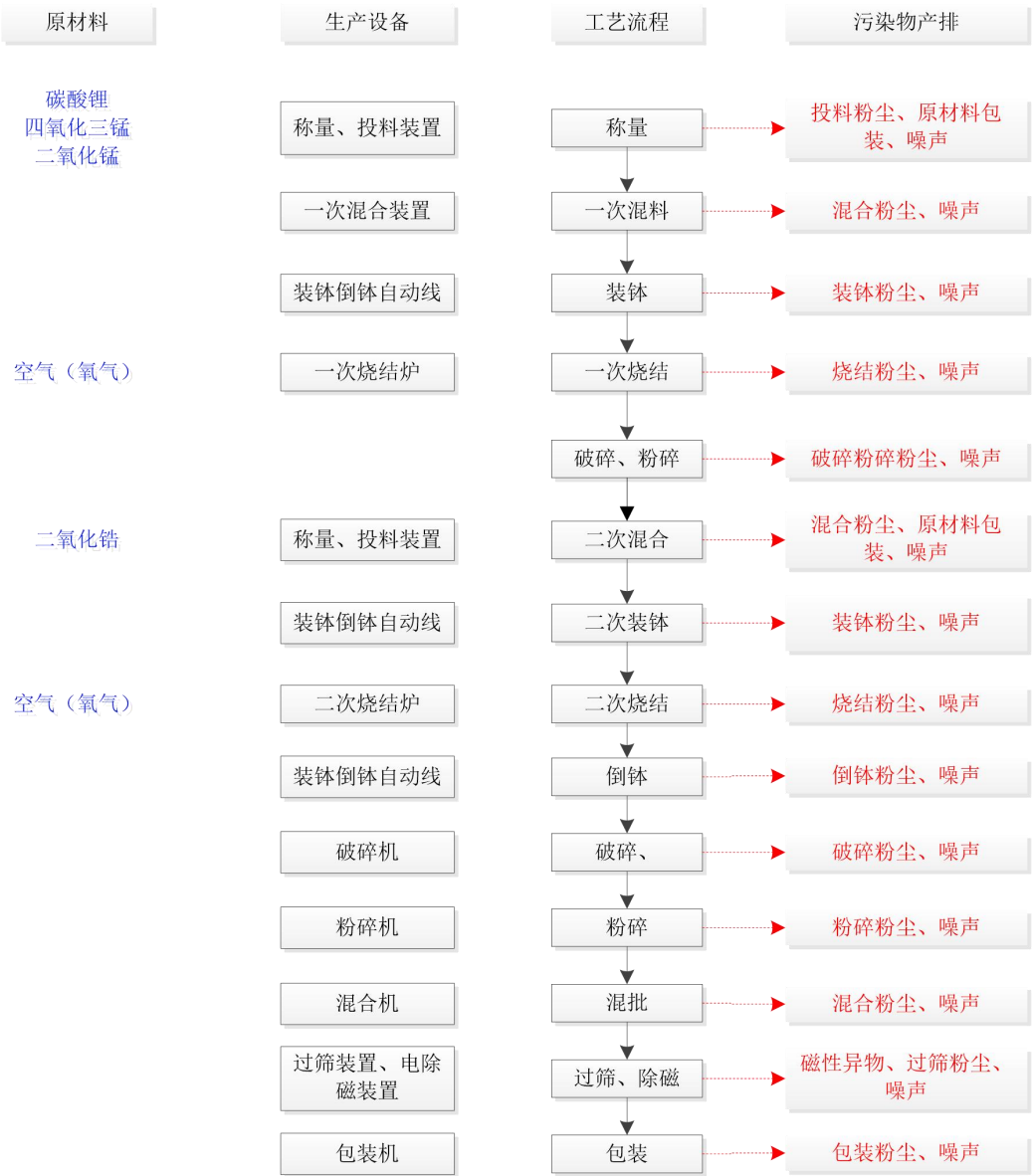
图 2-2 锰酸锂电池正极材料生产工艺流程图
